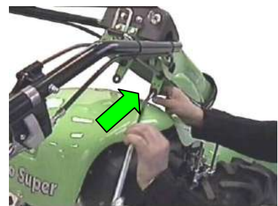
8 – Volver a colocar las palancas, cada una en su sitio y sujetándolas con la presilla.
