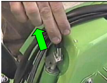
4 – Levantar completamente la leva de bloqueo del manillar
