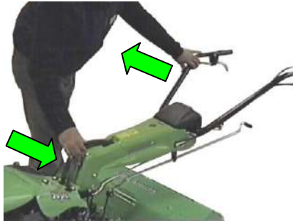
5 – Sujetar la leva y con la otra mano girar el manillar.
