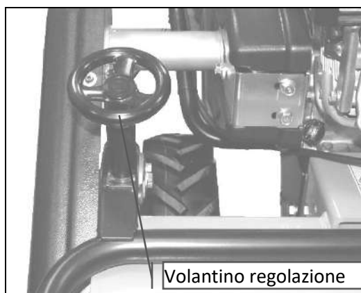
Fig. 13 “Volantino” de regulación de la altura de corte
